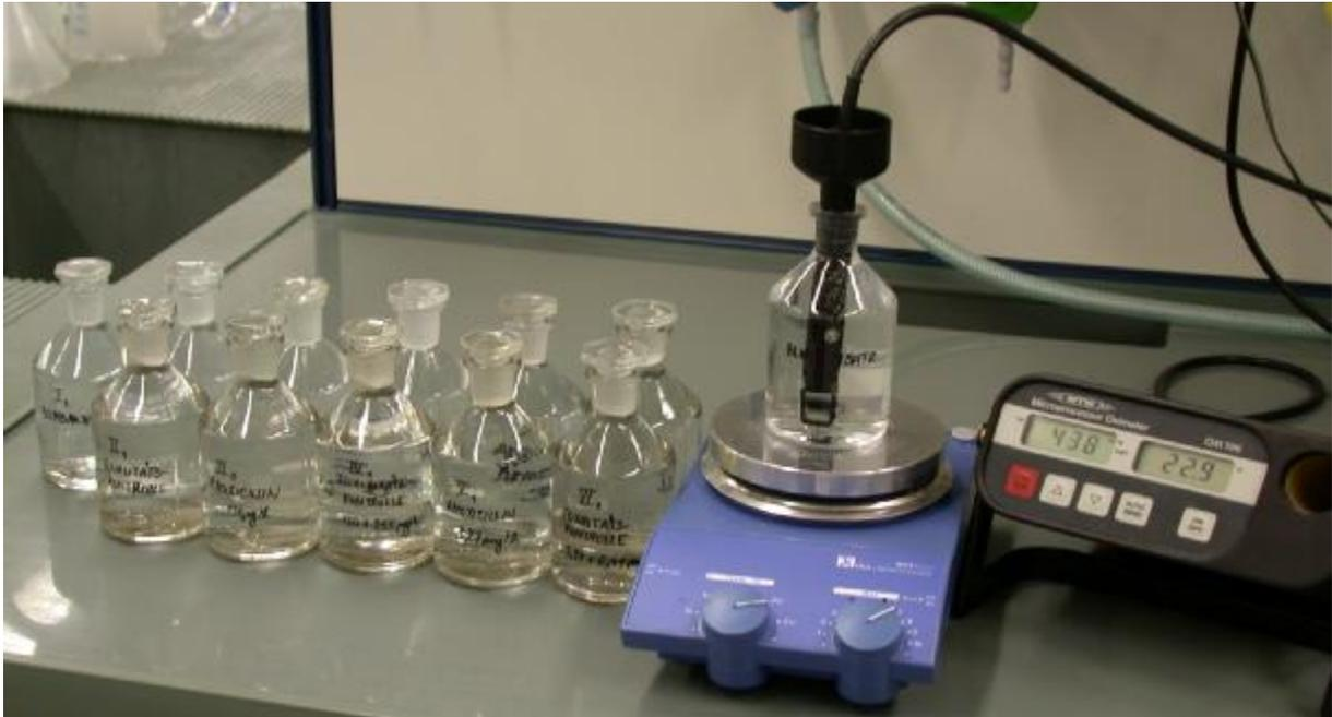
Abb. 10: Messung des gelösten Sauerstoffs im Closed Bottle Test
