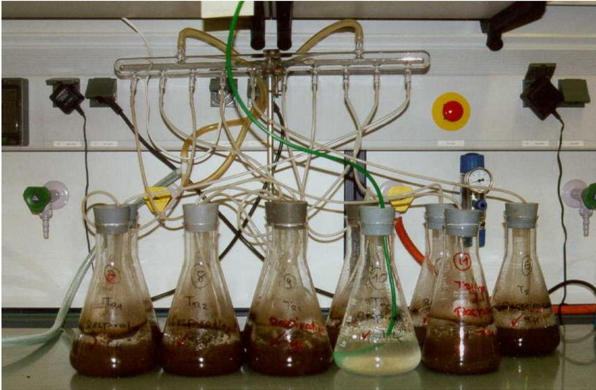
Abb. 14: Aufbau des Respirationshemmtests
