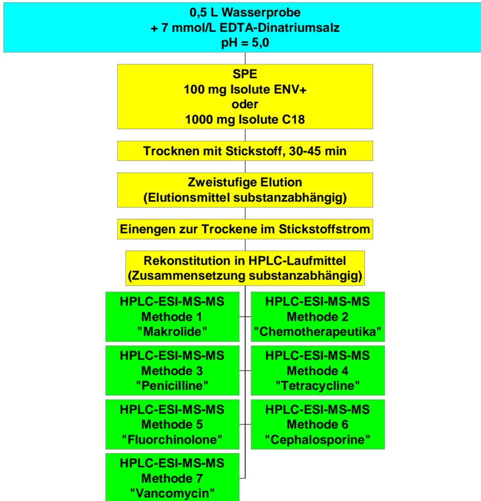
Abb. 4: Vorgehensweise bei der spurenanalytischen Bestimmung von Antibiotika-Rückständen aus Wasser mittels Hochleistungsflüssigkeitschromatografie gekoppelt mit der Elektrospray-Tandem-Massenspektrometrie (HPLC-ESI-MS-MS) nach Fest-Flüssig-Extraktion.
