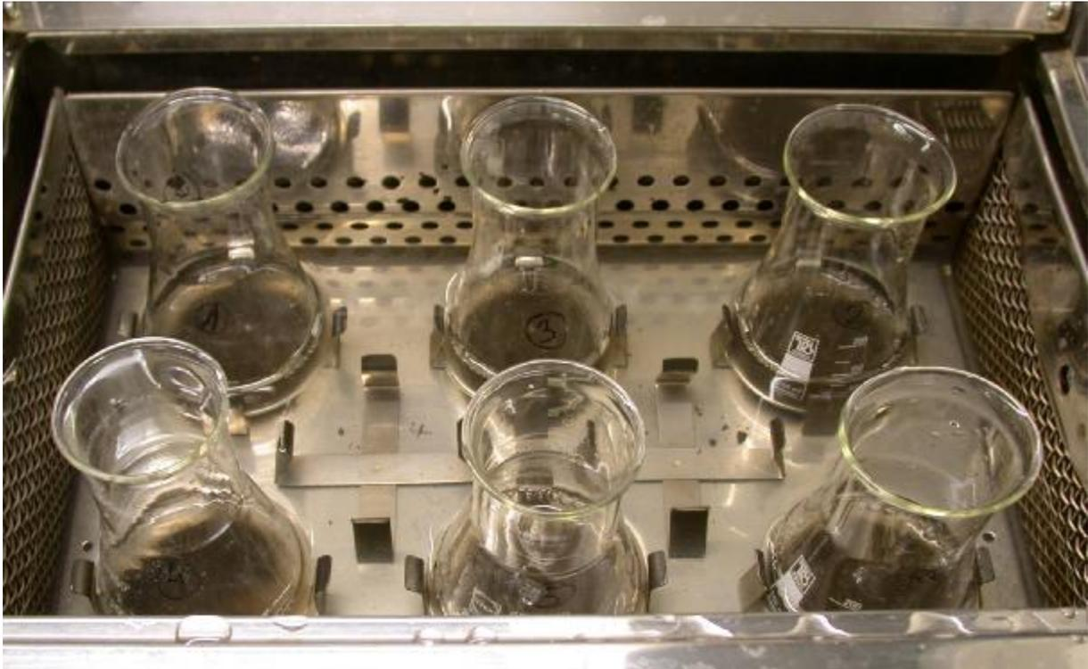
Abb. 15: Schüttelbad mit Testansätzen des Nitrifikationshemmtests
